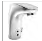
HANSAELECTRA Waschtisch-Elektronik- Batterie, DN 15 Netzbetrieb 9 V oder 12 V 6442 1109 verchromt berührungslos elektronisch gesteuert (Infrarot), inkl. Netzteil und Anschlusskabel, für offene Heißwasserbereiter, Bluetooth®-fähig Ausladung: 112 mm
