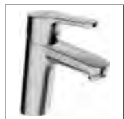
HANSAPRIMO XL Waschtisch-Einhand-Einlochbatterie, DN 15 4937 2203 verchromt ohne Ablaufgarnitur, Anschluss über flexible Druckschläuche Ausladung: 111 mm
