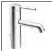
HANSADESIGNO Waschtisch-Einhand-Einlochbatterie, DN 15 5171 2273 verchromt Ablaufgarnitur (Metall), Anschluss mit flexiblen Druckschläuchen Ausladung: 125 mm
