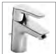
HANSAPOLO Waschtisch-Einhand-Einlochbatterie, DN 15 5140 2293 verchromt Ablaufgarnitur (Metall), Anschluss mit flexiblen Druckschläuchen Ausladung: 103 mm
