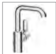
HANSAPRIMO Waschtisch-Einhand-Einlochbatterie, DN 15 4954 2203 verchromt Ablaufgarnitur (Metall), Anschluss mit flexiblen Druckschläuchen Ausladung: 142 mm
