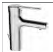
HANSARONDA Waschtisch-Einhand- Einlochbatterie, DN 15 0309 2273 verchromt Ablaufgarnitur (Metall), Anschluss mit flexiblen Druckschläuchen Ausladung: 100 mm
