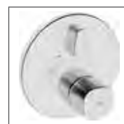
HANSALIVING Fertigmontageset mit Funktionseinheit Wannen-Thermostat- Batterie, DN 15 (G 1/2) mit Sicherungseinrichtung passend zu HANSABLUEBOX Einbaukörper* 8114 3552 verchromt mit integrierter keramischer Mengenregulierung, schraubenlose Rosette, Rosette rund, Ø 170 mm, Funktionseinheit mit BLUESWITCH Umstellung und Abspernung
