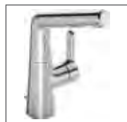
HANSADESIGNO STYLE Waschtisch-Einhand-Einlochbatterie, DN 15 5103 2283 verchromt Ablaufgarnitur (Metall), Anschluss mit flexiblen Druckschläuchen Ausladung: 150 mm
