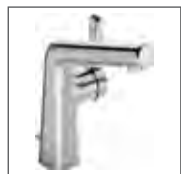
HANSADESIGNO STYLE Waschtisch-Einhand-Einlochbatterie, DN 15 5189 2283 34 rosegold Mikado® Strahlregler, Ablaufgarnitur (Metall), Anschluss mit flexiblen Druckschläuchen Ausladung: 130 mm
