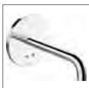
HANSAELECTRA Fertigmontageset mit Funktionseinheit Waschtisch-Elektronik-Batterie für Wandeinbau, DN 15 (G 1/2) für Kalt- oder Mischwasser-Anschluss passend zu HANSABLUEBOX Einbaukörper* 8180 2110 verchromt Ausladung: 245 mm
