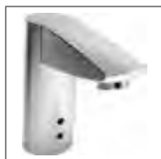
HANSAELECTRA Waschtisch-Elektronik-Batterie, DN 15 Batteriebetrieb 6491 2211 verchromt berührungslos elektronisch gesteuert (Infrarot), ohne Ablaufgarnitur, Hygienespülung nach 72 h für 30 sec werksseitig aktiviert Ausladung: 115 mm
