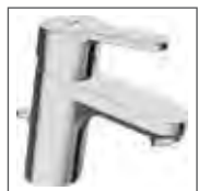
HANSAPRIMO Waschtisch-Einhand-Einlochbatterie, DN 15 4940 2203 verchromt Ablaufgarnitur (Metall), Anschluss über flexible Druckschläuche Ausladung: 107 mm
