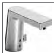
HANSASTELA Waschtisch-Elektronik-Batterie, DN 15 Netzbetrieb (inkl. Netzteil) 5712 2201 verchromt berührungslos elektronisch gesteuert (Infrarot), mit Ablaufgarnitur (Metall) Ausladung: 126 mm
