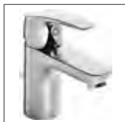
HANSA PINTO Waschtisch-Einhand- Einlochbatterie, DN 15 4504 2283 verchromt Ablaufgarnitur (Metall), Anschluss mit flexiblen Druckschläuchen, HANSA 3S-Installation Ausladung: 107 mm
