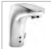
HANSAELECTRA Waschtisch-Elektronik- Batterie, DN 15 Netzbetrieb 6443 2000 verchromt berührungslos elektronisch gesteuert (Infrarot), ohne Ablaufgarnitur, umbaubar für Kalt- oder Mischwasseranschluss, ohne Netzteil Ausladung: 112 mm
