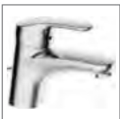
HANSAMIX Waschtisch-Einhand-Einlochbatterie, DN 15 0109 2183 00006 verchromt als Energiespar-Variante, Ablaufgarnitur (Metall), Anschluss über Kupferrohre Ausladung: 141 mm
