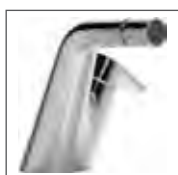
HANSASIGNATUR Einhand-Einlochbatterie für Bidet, DN 15 5508 3203 verchromt Ablaufgarnitur (Metall), Anschluss mit flexiblen Druckschläuchen Ausladung: 144 mm
