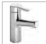
HANSADESIGNO STYLE Waschtisch-Einhand-Einlochbatterie, DN 15 5172 2283 verchromt ohne Ablaufgarnitur, HANSA 3S-Installation, Anschluss mit flexiblen Druckschläuchen Ausladung: 119 mm
