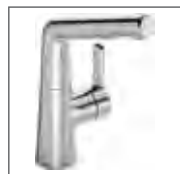
HANSADESIGNO STYLE Waschtisch-Einhand-Einlochbatterie, DN 15 5149 2283 verchromt ohne Ablaufgarnitur, HANSA 3S-Installation, Anschluss mit flexiblen Druckschläuchen Ausladung: 150 mm
