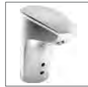
HANSAELECTRA Waschtisch-Elektronik- Batterie, DN 15 Batteriebetrieb 6447 2211 verchromt berührungslos elektronisch gesteuert (Infrarot), ohne Ablaufgarnitur, Hygienespülung nach 72 h für 30 sec werksseitig aktiviert Ausladung: 85 mm
