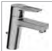
HANSAWIST XL Waschtisch-Einhand-Einlochbatterie, DN 15 0903 1185 verchromt ⚡ Bügelhebel (Metall), Anschluss über Kupferrohre, Ablaufgarnitur Ausladung: 123 mm
