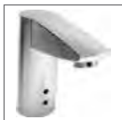
HANSAELECTRA Waschtisch-Elektronik-Batterie, DN 15 Batteriebetrieb 6491 2210 verchromt berührungslos elektronisch gesteuert (Infrarot), ohne Ablaufgarnitur Ausladung: 115 mm
