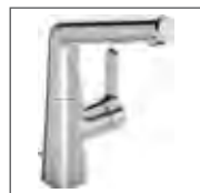
HANSADESIGNO STYLE Waschtisch-Einhand-Einlochbatterie, DN 15 5121 1183 verchromt Ablaufgarnitur (Metall), HANSA 3S-Installation Ausladung: 150 mm
