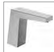
HANSALOFT Waschtisch-Elektronik- Batterie, DN 15 5749 2211 verchromt berührungslos elektronisch gesteuert (Infrarot), mit Ablaufgarnitur (Metall) Ausladung: 143 mm
