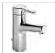
HANSADESIGNO STYLE Waschtisch-Einhand-Einlochbatterie, DN 15 5191 1183 verchromt Ablaufgarnitur (Metall), HANSA 3S-Installation, Anschluss über Druckschläuche G3/8 Ausladung: 119 mm
