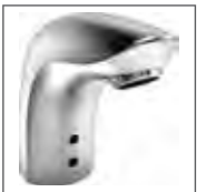
HANSAELECTRA Waschtisch-Elektronik- Batterie, DN 15 Batteriebetrieb 6440 2210 verchromt berührungslos elektronisch gesteuert (Infrarot), für Kalt- oder Mischwasser-Anschluss, ohne Ablaufgarnitur Ausladung: 96 mm
