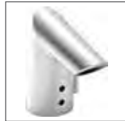
HANSAFIT Waschtisch-Elektronik- Batterie, DN 15 Netzbetrieb 6541 2000 verchromt berührungslos elektronisch gesteuert (Infrarot), ohne Ablaufgarnitur, inkl. Netzteil und Anschlusskabel, flexible Anschlusschläuche Ausladung: 85 mm
