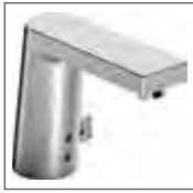
HANSATELA Waschtisch-Elektronik- Batterie, DN 15 Netzbetrieb 5712 2201 verchromt berührungslos elektronisch gesteuert (Infrarot), inkl. Netzteil und Anschlusskabel, Ablaufgarnitur mit Push-Betätigung Ausladung: 126 mm
