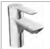
HANSALIGNA Waschtisch-Einhand- Einlochbatterie XS, DN 15 0607 2203 verchromt Ablaufgarnitur (Metall), Anschluss mit flexiblen Druckschläuchen Ausladung: 94 mm
