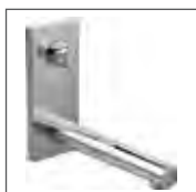
HANSASIGNATUR Fertigmontageset mit Funktionseinheit Waschtisch-Elektronik-Batterie für Wandeinbau, DN 15 (G 1/2) Netzbetrieb passend zu HANSAMATRIX Einbaukörper* 4491 2010 verchromt mit thermostatischer Temperaturmischung, berührungslos elektronisch gesteuert (Infrarot), inkl. Netzteil und Anschlusskabel Ausladung: 195 mm
