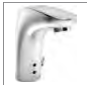
HANSAELECTRA Waschtisch-Elektronik- Batterie, DN 15 Batteriebetrieb 6443 2210 verchromt berührungslos elektronisch gesteuert (Infrarot), ohne Ablaufgarnitur, umbaubar für Kalt- oder Mischwasseranschluss Ausladung: 112 mm
