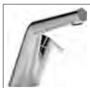
HANSASIGNATUR Waschtisch-Einhand-Einlochbatterie, DN 15 5505 2281 verchromt Auslauf schwenkbar, Ablaufgarnitur mit Push-Betätigung, herausziehbare Schlauchbrause Ausladung: 168 mm
