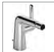
HANSADESIGNO STYLE Einhand-Einlochbatterie, DN 15 5198 3283 verchromt für Sitzwaschbecken, Ablaufgarnitur (Metall), Anschluss mit flexiblen Druckschläuchen Ausladung: 119 mm
