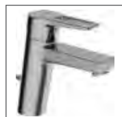
HANSATWIST XL Waschtisch-Einhand-Einlochbatterie, DN 15 0901 2285 verchromt Bügelhebel (Metall), Ablaufgarnitur (Metall), Anschluss mit flexiblen Druckschläuchen Ausladung: 123 mm
