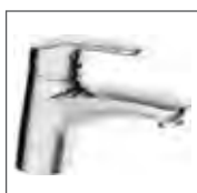
HANSAMIX Waschtisch-Einhand-Einlochbatterie, DN 15 0118 2183 verchromt ohne Ablaufgarnitur, Auslauf schwenkbar, Anschluss über Kupferrohre Ausladung: 157 mm
