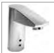
HANSAELECTRA Waschtisch-Elektronik-Batterie, DN 15 Netzbetrieb 6491 2011 verchromt berührungslos elektronisch gesteuert (Infrarot), inkl. Netzteil und Anschlusskabel, ohne Ablaufgarnitur, Hygienespülung nach 72 h für 30 sec werksseitig aktiviert Ausladung: 115 mm
