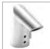
HANSAFIT Waschtisch-Elektronik-Batterie, DN 15 Batteriebetrieb 6541 2210 verchromt berührungslos elektronisch gesteuert (Infrarot), ohne Ablaufgarnitur, flexible Anschlussschläuche Ausladung: 85 mm
