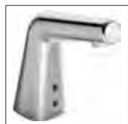
HANSADESIGNO STYLE Waschtisch-Elektronik-Batterie, DN 15 Batteriebetrieb 5193 2201 verchromt berührungslos elektronisch gesteuert (Infrarot), Mikado® Strahlregler, ohne Ablaufgarnitur Ausladung: 100 mm
