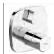
HANSALIVING Fertigmontageset mit Funktionseinheit Wannen-Thermostat- Batterie, DN 15 (G 1/2) mit Sicherungseinrichtung passend zu HANSABLUEBOX Einbaukörper* 8114 3572 verchromt mit integrierter keramischer Mengenregulierung, schraubenlose Rosette, Rosette soft edge - weiche Kanten - abgerundet, Funktionseinheit mit BLUESWITCH Umstellung und Abspernung
