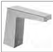
HANSALOFT Waschtisch-Elektronik- Batterie, DN 15 Netzbetrieb 5748 2201 verchromt berührungslos elektronisch gesteuert (Infrarot), inkl. Netzteil und Anschlusskabel, Ablaufgarnitur mit Push-Betätigung Ausladung: 143 mm
