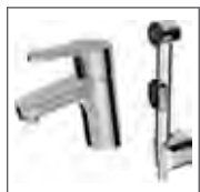
HANSAPRIMO Waschtisch-Einhand-Einlochbatterie, DN 15 4946 2203 verchromt mit Funktionsbrause, ohne Ablaufgarnitur, Anschluss mit flexiblen Druckschläuchen Ausladung: 107 mm
