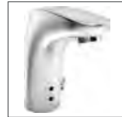
HANSAELECTRA Waschtisch-Elektronik- Batterie, DN 15 Netzbetrieb 9 V oder 12 V 6443 2009 verchromt berührungslos elektronisch gesteuert (Infrarot), Bluetooth® fähig, ohne Ablaufgarnitur, flexible Anschlusschläuche Ausladung: 112 mm
