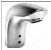
HANSAELECTRA Waschtisch-Elektronik- Batterie, DN 15 Batteriebetrieb 6440 2211 verchromt berührungslos elektronisch gesteuert (Infrarot), für Kalt- oder Mischwasser-Anschluss, ohne Ablaufgarnitur, Hygienespülung nach 72 h für 30 sec werksseitig aktiviert Ausladung: 96 mm
