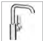
HANSAPRIMO Waschtisch-Einhand-Einlochbatterie, DN 15 4955 2203 verchromt ohne Ablaufgarnitur, Anschluss mit flexiblen Druckschläuchen Ausladung: 142 mm
