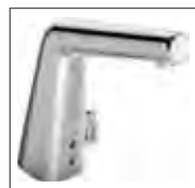
HANSADESIGNO STYLE Waschtisch-Elektronik-Batterie, DN 15 Netzbetrieb 5179 2221 verchromt berührungslos elektronisch gesteuert (Infrarot), inkl. Netzteil und Anschlusskabel, Ablaufgarnitur mit Push-Betätigung, flexible Anschlusschläuche Ausladung: 138 mm
