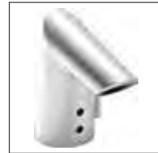
HANSAFIT Waschtisch-Elektronik- Batterie, DN 15 Batteriebetrieb 6541 2210 verchromt berührungslos elektronisch gesteuert (Infrarot), ohne Ablaufgarnitur, flexible Anschlusschläuche Ausladung: 85 mm
