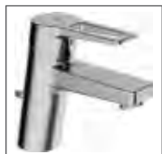
HANSATWIST Waschtisch-Einhand-Einlochbatterie, DN 15 0909 2285 verchromt Bügelhebel (Metall), Anschluss mit flexiblen Druckschläuchen Ausladung: 121 mm
