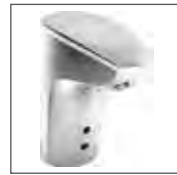
HANSAELECTRA Waschtisch-Elektronik- Batterie, DN 15 Batteriebetrieb 6447 2210 verchromt berührungslos elektronisch gesteuert (Infrarot), für Kalt- oder Mischwasser-Anschluss, ohne Ablaufgarnitur Ausladung: 85 mm
