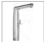
HANSADESIGNO STYLE Waschtisch-Elektronik-Batterie, DN 15 Netzbetrieb 5194 2211 verchromt berührungslos elektronisch gesteuert (Infrarot), inkl. Netzteil und Anschlusskabel, Ablaufgarnitur mit Push-Betätigung, flexible Anschlusschläuche Ausladung: 164 mm
