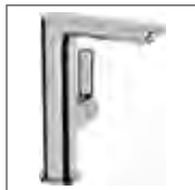
HANSALIGNA Waschtisch-Einhand- Einlochbatterie, DN 15 5535 2203 verchromt Auslauf schwenkbar, ohne Ablaufgarnitur, Anschluss mit flexiblen Druckschläuchen Ausladung: 116 mm
