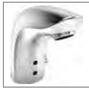
HANSAELECTRA Waschtisch-Elektronik- Batterie, DN 15 Netzbetrieb 6441 2001 verchromt berührungslos elektronisch gesteuert (Infrarot), inkl. Netzteil und Anschlusskabel, ohne Ablaufgarnitur, Hygienespülung nach 72 h für 30 sec werksseitig aktiviert Ausladung: 96 mm
