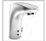
HANSAELECTRA Waschtisch-Elektronik- Batterie, DN 15 Batteriebetrieb 6443 2219 verchromt berührungslos elektronisch gesteuert (Infrarot), Bluetooth® fähig, ohne Ablaufgarnitur, flexible Anschlusschläuche Ausladung: 112 mm
