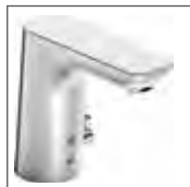
HANSALIGNA Waschtisch-Elektronik- Batterie, DN 15 Netzbetrieb (inkl. Netzteil) 0614 2201 verchromt berührungslos elektronisch gesteuert (Infrarot), mit Ablaufgarnitur (Metall) Ausladung: 110 mm
