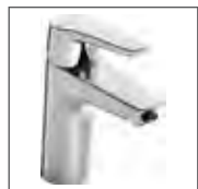
HANSAPOLO XL Waschtisch-Einhand-Einlochbatterie, DN 15 5152 2293 verchromt ohne Ablaufgarnitur, Anschluss mit flexiblen Druckschläuchen Ausladung: 110 mm
