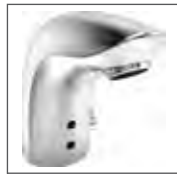
HANSAELECTRA Waschtisch-Elektronik- Batterie, DN 15 Batteriebetrieb 6441 2211 verchromt berührungslos elektronisch gesteuert (Infrarot), ohne Ablaufgarnitur, Hygienespülung nach 72 h für 30 sec werksseitig aktiviert Ausladung: 96 mm
