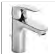
HANSA PINTO XL Waschtisch-Einhand- Einlochbatterie, DN 15 4501 2283 verchromt Ablaufgarnitur (Metall), Anschluss mit flexiblen Druckschläuchen, HANSA 3S-Installation Ausladung: 115 mm
