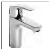
HANSA PINTO XL Waschtisch-Einhand- Einlochbatterie, DN 15 4502 2283 verchromt ohne Ablaufgarnitur, Anschluss mit flexiblen Druckschläuchen, HANSA 3S-Installation Ausladung: 115 mm
