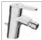
HANSAPRIMO Einhand-Einlochbatterie, DN 15 für Sitzwaschbecken 4943 3203 verchromt Ablaufgarnitur (Metall), Anschluss über flexible Druckschläuche Ausladung: 107 mm
