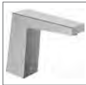
HANSALOFT Waschtisch-Elektronik- Batterie, DN 15 Batteriebetrieb 5749 2211 verchromt berührungslos elektronisch gesteuert (Infrarot), Ablaufgarnitur mit Push-Betätigung Ausladung: 143 mm
