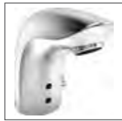
HANSAELECTRA Waschtisch-Elektronik- Batterie, DN 15 Batteriebetrieb 6441 2210 verchromt berührungslos elektronisch gesteuert (Infrarot), ohne Ablaufgarnitur Ausladung: 96 mm
