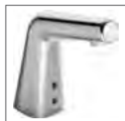
HANSADESIGNO STYLE Waschtisch-Elektronik-Batterie, DN 15 Netzbetrieb 5193 2211 verchromt inkl. Netzteil und Anschlusskabel, Mikado® Strahlregler, ohne Ablaufgarnitur, Hygienespülung nach 72 h für 30 sec Anschlussseitig aktiviert Ausladung: 100 mm
