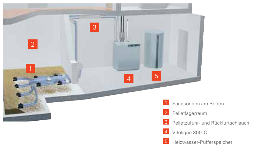
Lagerraum ohne Schrägboden mit Zuführung zum Pelletkessel über Saugsonden
