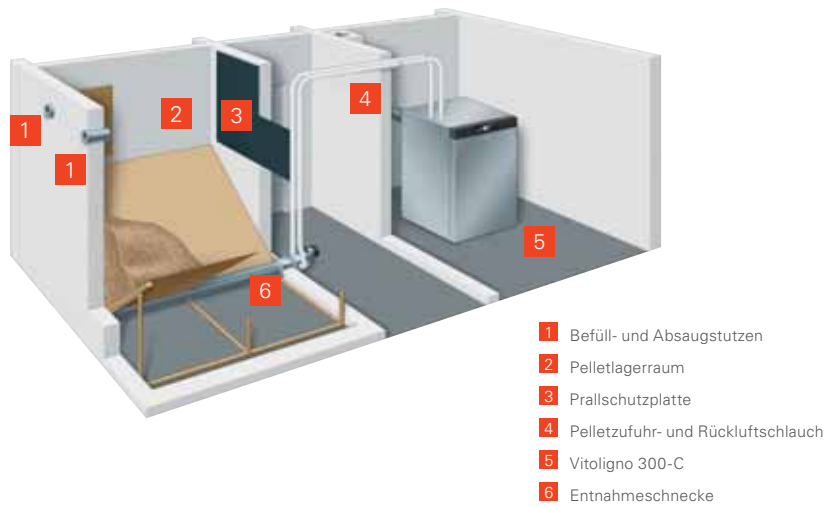
Einbaubeispiel Lagerraum mit Zuführung zum Pelletkessel durch Vakuum-Saugsystem
