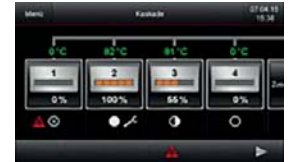
Vitotrol 350-C – Grundanzeige der Kaskade für bis zu vier Holzheizkessel
