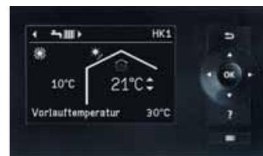
Bedienung von Vitovent 300-C über die Wärmepumpenregelung Vitotronic 200, Typ WO1C
