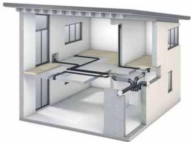
**VORTEILE DER ZENTRALEN VERTEILUNG IN DER ABGEHÄNGTEN DECKE**
